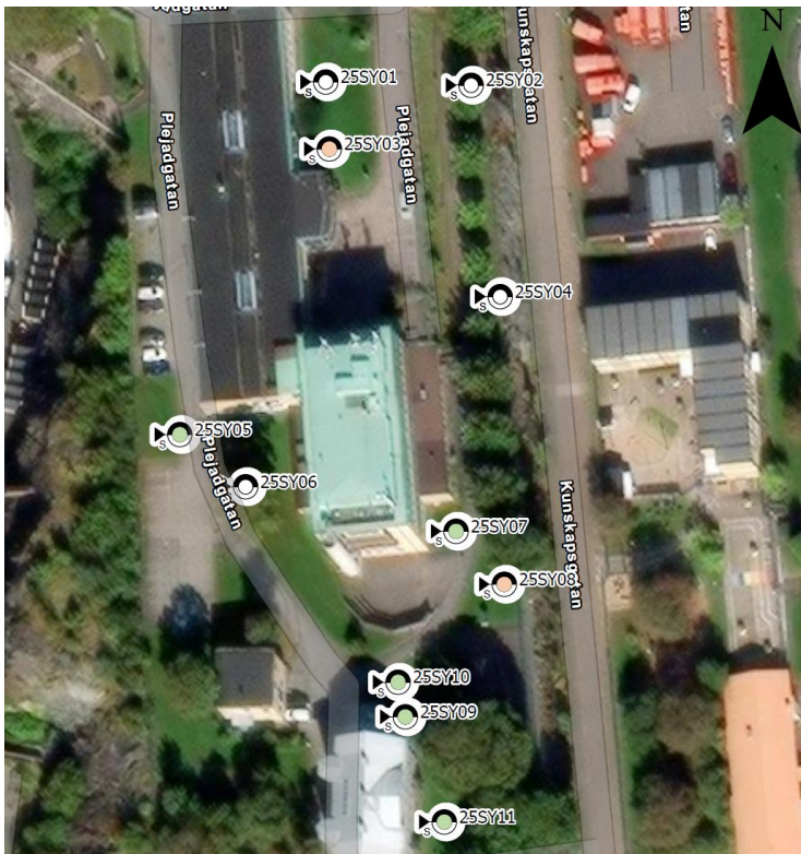
Figur 5. Grön symbol: Mätbart åtgärdsgränser för Norra Älvstranden underskrids >1 meters djup. Röd symbol: Mätbart åtgärdsgränser överskreds >1 meters djup. Vit symbol: Bergöveryta påträffas på <1 meters djup.
